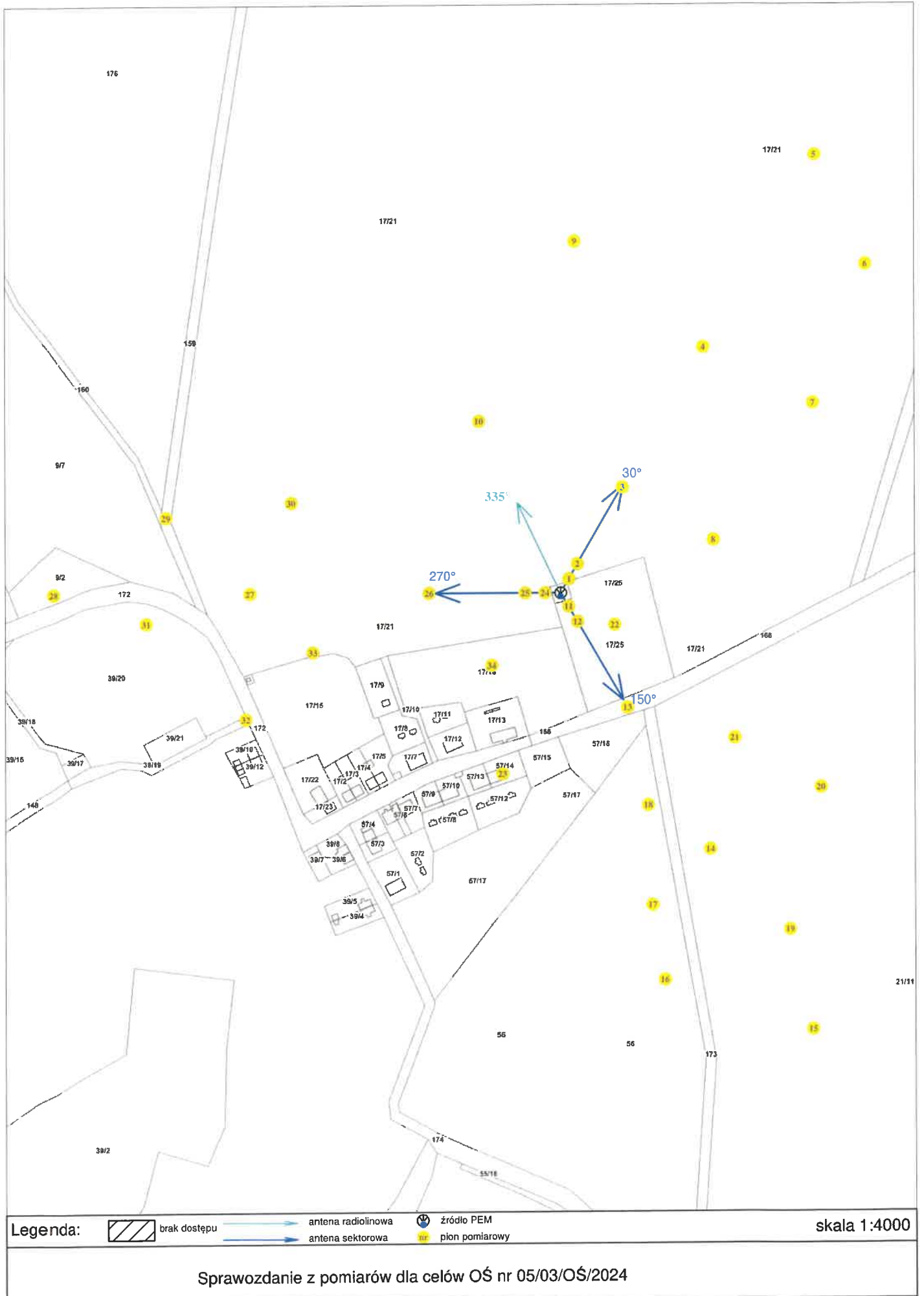
Rys. 2 Lokalizacja pionów pomiarowych
